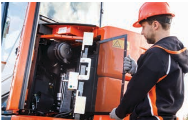
O radiador tem uma rede de proteção contra poeiras, fácil de limpar.
